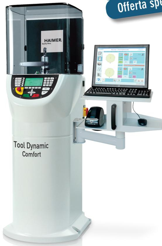
**Tool Dynamic TD Comfort** è la macchina bilanciatrice più precisa del mondo con una ripetibilità di < 0,5 gmm con l'indicatore ottico dello squilibrio mediante un laser di precisione arrivate velocemente all'obiettivo. Inoltre, con il nuovo software di bilanciatura di questa macchina, è possibile compensare lo squilibrio mediante la fresatura ed è facile da utilizzare.
