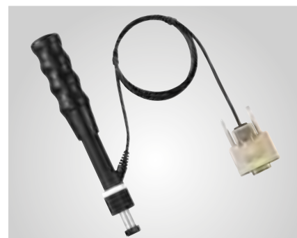
Dispositivo di impatto HLDL UD-414 Utilizzare per denti degli ingranaggi, angoli saldati, ecc.
