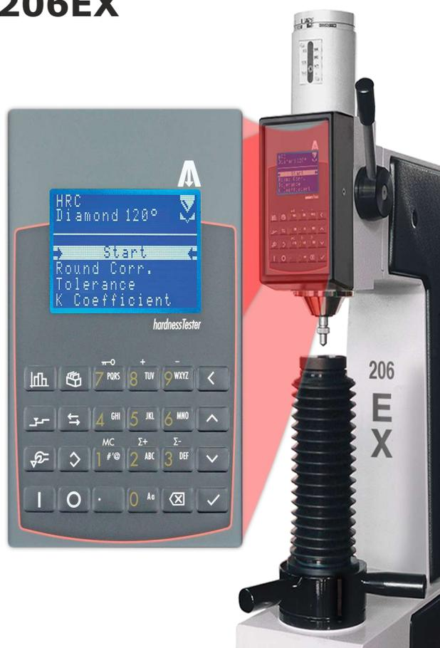
206 EX è un durometro da banco, veloce e facilissimo da usare, con alti standard di precisione.
