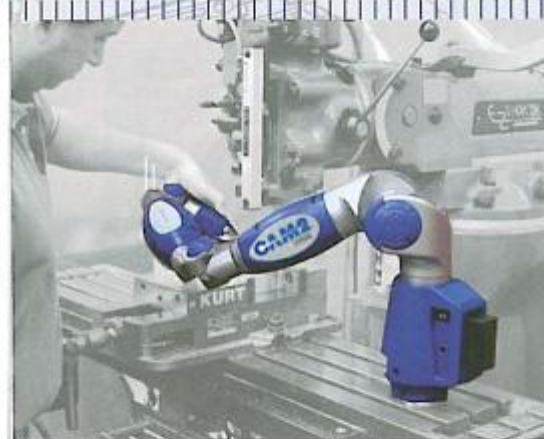
Misurazioni sulla macchina utensile.
