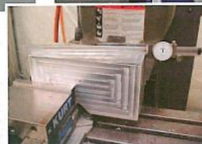
Il Gage sostituisce gli strumenti di misura manuale ed impedisce misurazioni errate.
