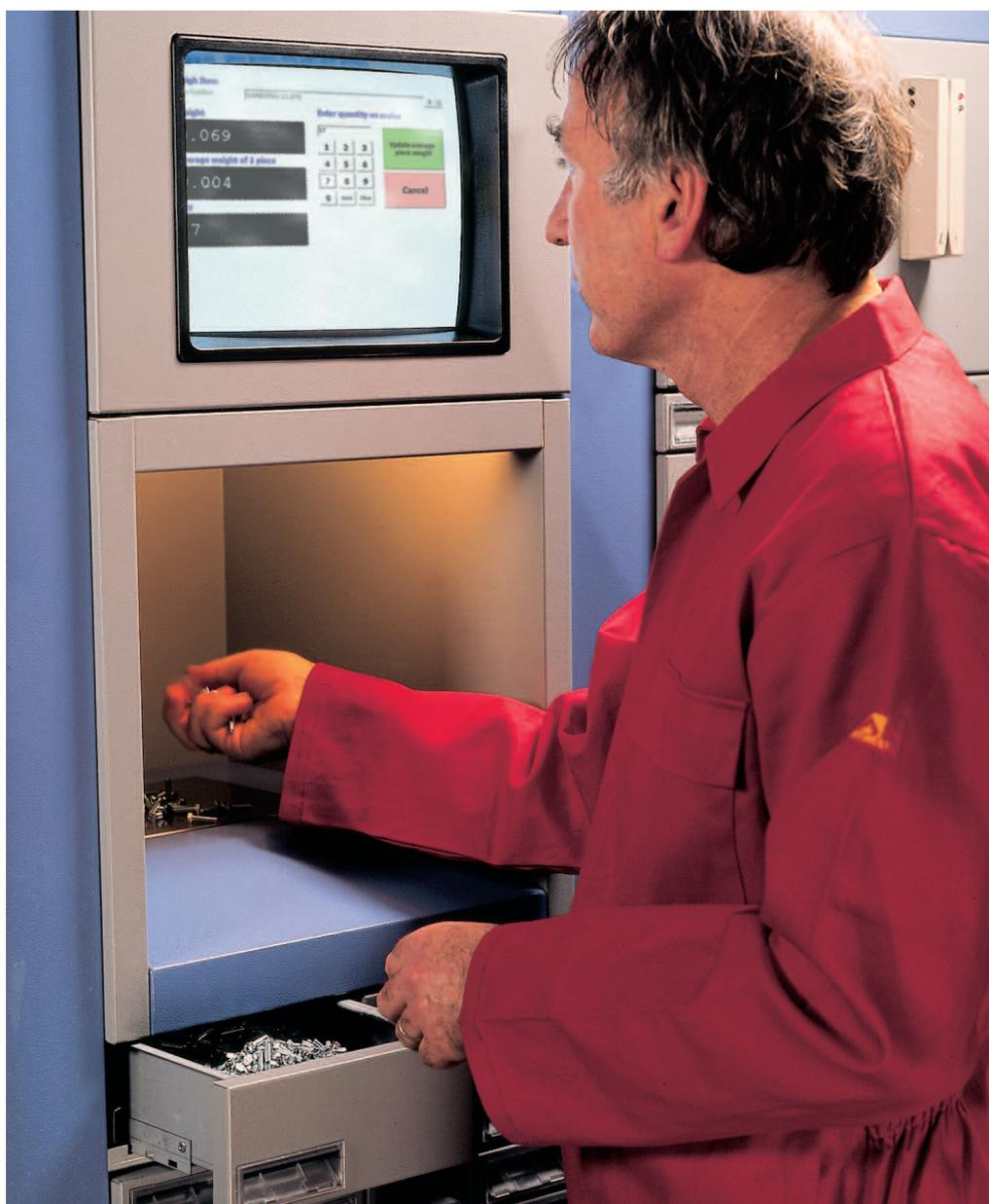
Una bilancia estremamente accurata permette di contare, secondo il loro peso, articoli come rondelle viti e rivetti.
