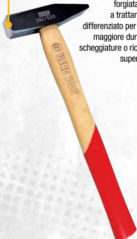
Testa in acciaio al Carbonio forgiata e sottoposta a trattamento termico differenziato per garantire una maggiore durata ed evitare scheggiature o ricalcature della superficie battente
