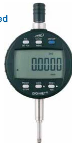
Comparatore digitale **con trasmissione wireless integrata**, con display a cristalli liquidi, **grado di protezione IP 42**, cassa in alluminio, **quadrante girevole 280°**, stelo in acciaio temprato con punta tastatrice sostituibile M 2,5 mm, codolo di serraggio Ø 8 mm tolleranza h 6, precisione secondo norma interna.
