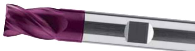
Fresa codolo cilindrico DIN 6535-HB in metallo duro integrale con rivestimento TiAIN, a 4 taglienti con angolo evolvente variabile 35/38°, la spaziatura dei taglienti e la particolare spoglia permettono lavorazioni di sgrossatura e finitura con basse vibrazioni, elevata silenziosità, taglio centrale, angolo di raccordo 45°. **Per lavorazioni di acciai inox e leghe di titanio.**
