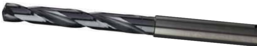
Punta codolo cilindrico in **metallo duro integrale, rettificata**, rivestita Focus, norma DIN 6537L, codolo a norma DIN 6535HA. **Geometria specifica 140°**, affilatura su piani, **con fori di refrigerazione** per eseguire forature 5xD. **Per lavorazioni di acciai inox resistenti al calore, leghe di titanio, Hastelloy®, Iconel®, Nimonic®.**
