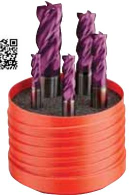
Fresa codolo cilindrico DIN 6535-HB in metallo duro integrale con rivestimento TiAlN, a 4 taglienti con angolo evolvente variabile 35/38°, la spaziatura dei taglienti e la particolare spoglia permettono lavorazioni di sgrossatura e finitura con basse vibrazioni, elevata silenziosità, taglio centrale, angolo di raccordo 45°. **Per lavorazioni di acciai inox e leghe di titanio.**
