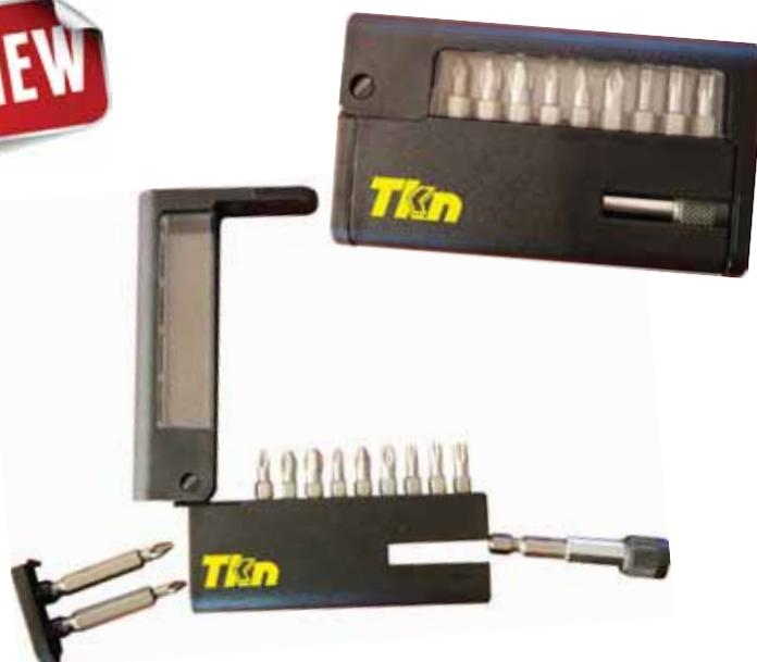
Assortimento di inserti con **raccordo portainseriti magnetico**, inserti con attacco esagonale da 1/4" DIN 3126 C 6,3 ISO 1173, in acciaio UNI 73Mov52 stampato e sabbiato con durezza superficiale 59 ± 2 HRC, **esecuzione robusta**.
