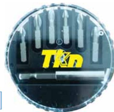
Assortimento di inserti con **raccordo portainseriti magnetico**, inserti con attacco esagonale da 1/4" DIN 3126 C 6,3 ISO 1173, in acciaio UNI 73Mov52 stampato e sabbiato con durezza superficiale 59 ± 2 HRC, **esecuzione robusta**.
