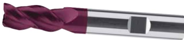
Fresa codolo cilindrico DIN 6535-HB in metallo duro integrale con rivestimento TiAIN, a 3 taglienti con angolo evolvente variabile 35/38°, la spaziatura dei taglienti e la particolare spoglia permettono lavorazioni di sgrossatura e finitura con basse vibrazioni, elevata silenziosità, taglio centrale, angolo di raccordo 45°, concentricità <0,01 mm. **Per lavorazioni di acciai inox e leghe di titanio.**
