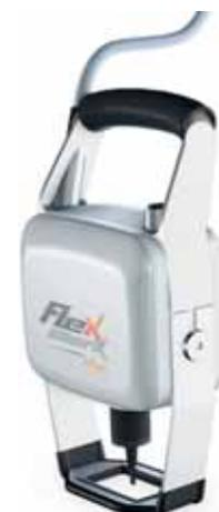
Marcatrice portatile flexmark mini composta da testa di marcatura ed unità di comando di nuova generazione, finestra di marcatura 60x30 mm, design compatto e peso ridotto, marcatura alfanumerica lineare, circolare ed angolare, font a matrice singola, doppia e continua collegamento tramite RS-232 e USB, non necessita di regolazione in altezza.
