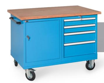
BANCO DA LAVORO SU RUOTE (Ø 150 MM) CON CASSETTIERA A 4 CASSETTI (2 H 100 MM; 1 H 150 MM; 1 H 200 MM) CON ANTA A BATTENTE E PIANO INTERNO. PORTATA 450 KG.
