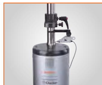
Ispesione utilizzando la sonda a leva (sonda induttiva)
